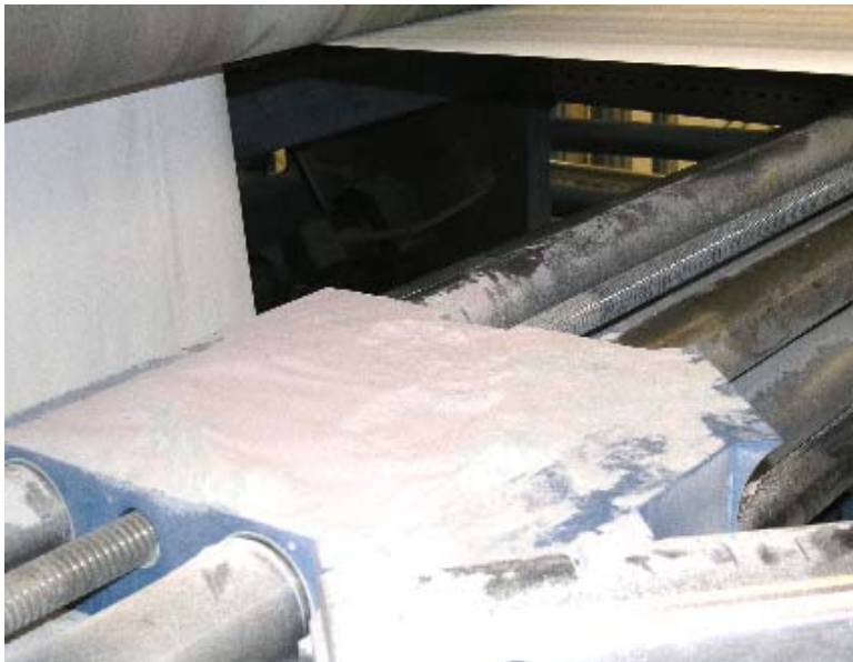
Kuva 4. Painokoneen pinnoille saattaa kerääntyä paljonkin pölyä, joka esim. paineilmalla siivottaessa voi muodostaa räjähdyskelpoisen pöly-ilmaseoksen.
