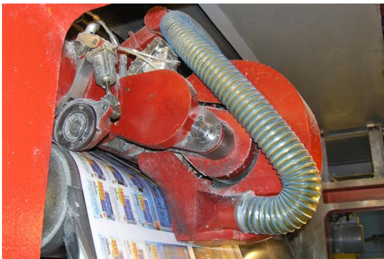
Kuva 9. Painokoneen leikkurista tulevan pölyn aiheuttamaa räjähdysvaaraa torjutaan imemällä pöly pölynpoistojärjestelmään
